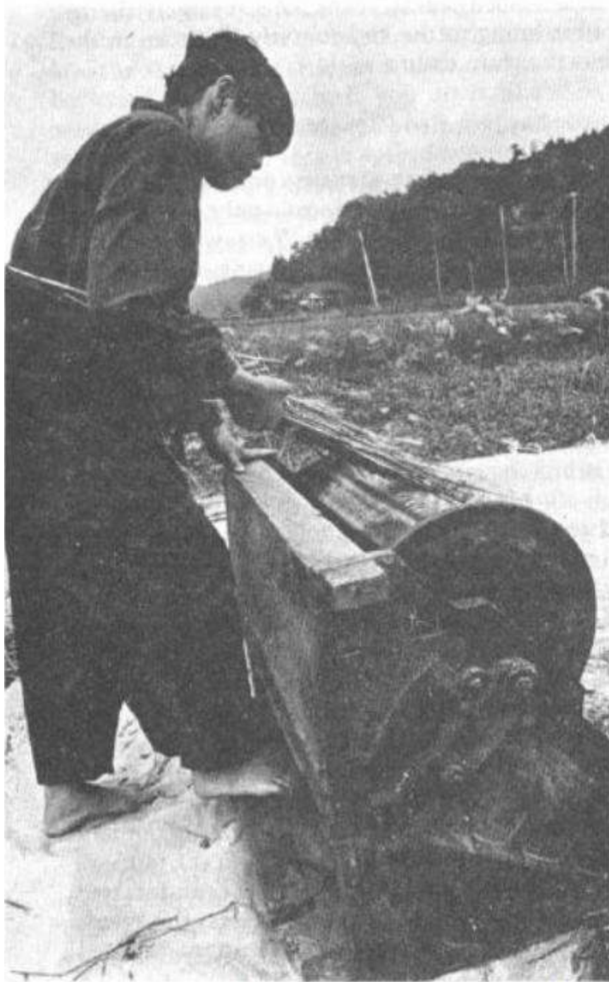
Đập lúa bằng trống xoay dùng chân truyền thống. Lúa được tách ra và lưu trữ còn rơm thì được rải về lại cánh đồng.
